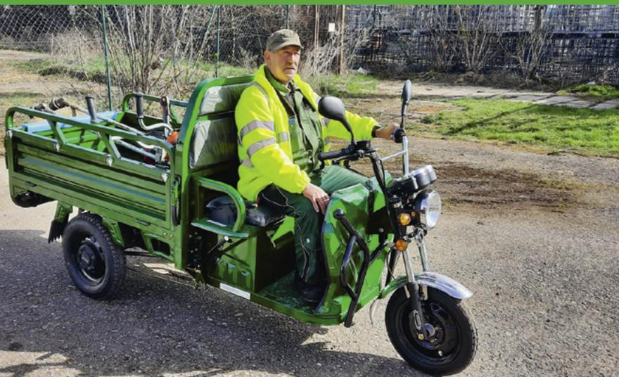
Das Carello Elektro-Lastendreirad „LDR 35“ ist ein Alleskönner – geländegängig, mit großer Ladefläche bis zu 370 kg Zuladung und einer kippbaren Pritsche. Als L2e-U klassifiziert, lassen sich mit bis zu 35 km/h jegliche Lieferungen und Transporte effizient und schnell erledigen.
